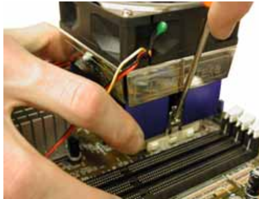
...puis avec un tournevis, fixer l'autre côté...
