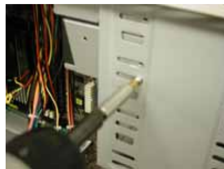
Bien visser le périphérique pour éviter toute vibration
