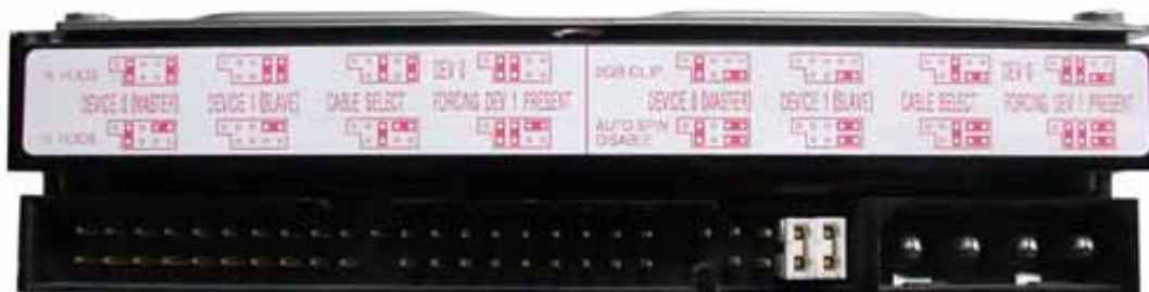
Configuration des jumpers pour la position maître/esclave sur un disque dur IBM
