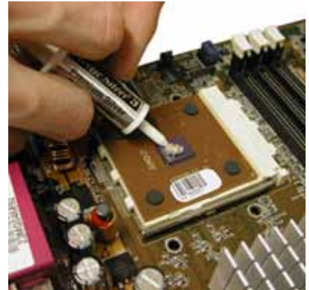
...et appliquer la pâte thermique.
